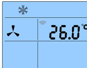
(圖 17)低速固定風速畫面
