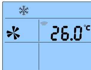
(圖 18)中速固定風速畫面
