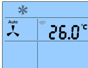
(圖 16)自動變換風速畫面
